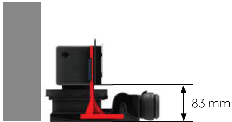
Минимальная высота скрытой части 83 мм
